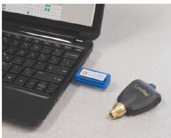
e-nyckel programmering via IR USB Stick eller uppdateringsenhet
